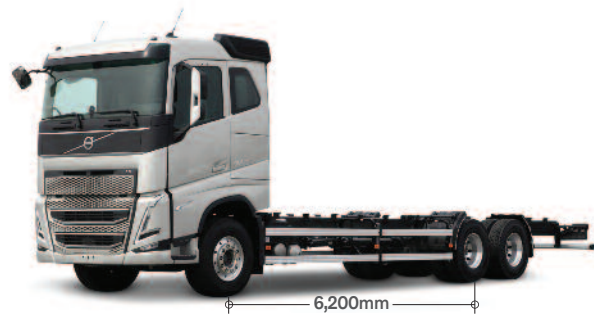
FH 500hp 6X4 후축 에어서스펜션 (축간거리 6,200/5,600mm)
