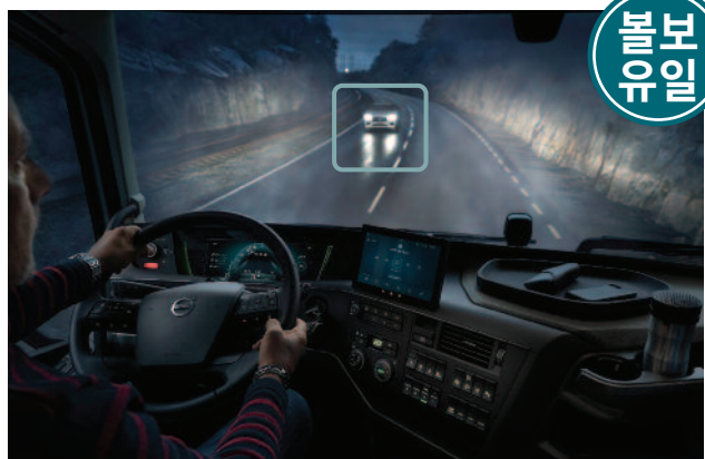
어댑티브 하이빔 LED 헤드라이트 (FH 6X4) 카메라가 상대 차량을 감지하게 되면 다른 영역의 조명은 유지하며 정밀 레이더의 LED제어로 상대 차량의 눈부심을 방지합니다
