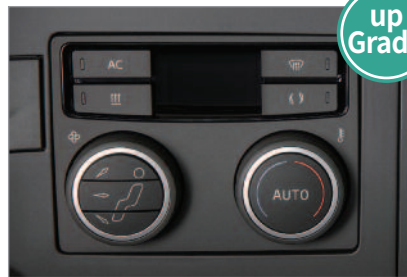
전자제어식 자동 공조장치 (전차종) (미스트/공기 센서, 공기 정화카본 필터)
