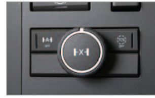
트랙션 컨트롤 (TCS) 미끄러지기 쉬운 도로에서 차량이 출발할 때 공회전 하지 않도록 제어해주는 장치입니다.
