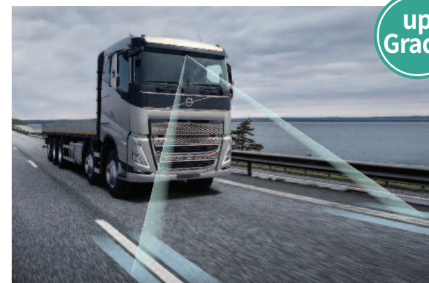
차선유지 지원 (스티어링 휠 보정) (FH 540hp 10X4) 차선표시를 감지하여 스티어링 휠 진동을 통해 운전자에게 경고하며, 트럭을 차선 중앙으로 다시 조향시킵니다.
