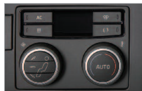
전자제어식 자동 공조장치 (전차중) (미스트/공기 센서, 공기 정화 카본 필터)
