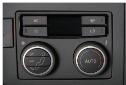
전자제어식 자동 공조장치 (전차중) (미스트/공기 센서, 공기정화카본 필터)
