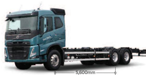
FM11 460hp 6X4 (리프서스펜션: 축간거리 5,200mm) (에어서스펜션: 축간거리 6,200/5,600mm)
