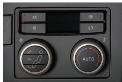
전자제어식 자동 공조장치(전자종) (미스트/공기 센서, 공기 정화 카본 필터, 자동 감시림방지)
