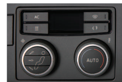
전자제어식 자동 공조장치 (전차종) (미스트/공기 센서, 공기 정화 카본 필터, 자동 김서림방지)
