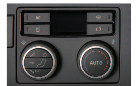
전자제어식 자동 공조장치(전차종) (미스트/공기 센서, 공기 정화카본필터, 자동 김서림방지)
