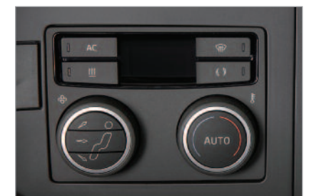
전자제어식 자동 공조장치(전차종) (미스트/공기 센서, 공기 정화카본 필터)
