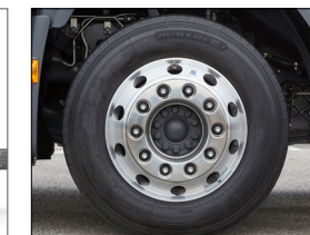
알루미늄 휠 적용 가벼워진 알루미늄 휠 적용으로 연비 및 특징 용이성 증대와 적재량이 개선되었습니다.
