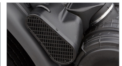
에어 인테이크 위치 변경 캡 후면 하단으로 위치 변경을 통한 특징 용이성 증대 및 적재량이 최적화되었습니다. (FE 4X2 6,100/5,000)
