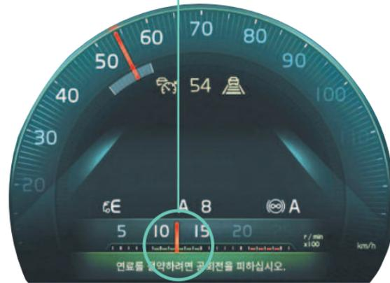
D13K엔진 최적 경제 속도구간: 1,000~1,400 rpm (가능한 1,200rpm 유지)
